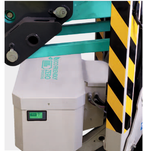
Compartimentul bateriilor de litiu: protejat și ușor accesibil pentru gestionarea ciclului de încărcare. Display LCD pentru afișarea stării de încărcare și a timpului rămas de utilizare a bateriei.
